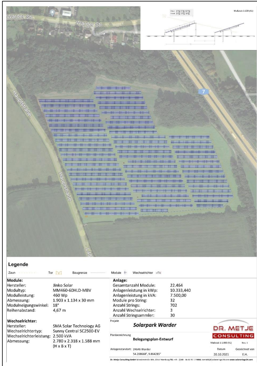
Abbildung 8: Belegungsplan-Entwurf des Solarpark Warder (DR. METJE CONSULTING; Stand 20.10.2021)
